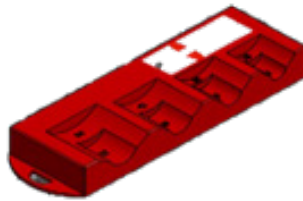
Fig.24 Dima "segna inserimento" per diametri 12 - 54
